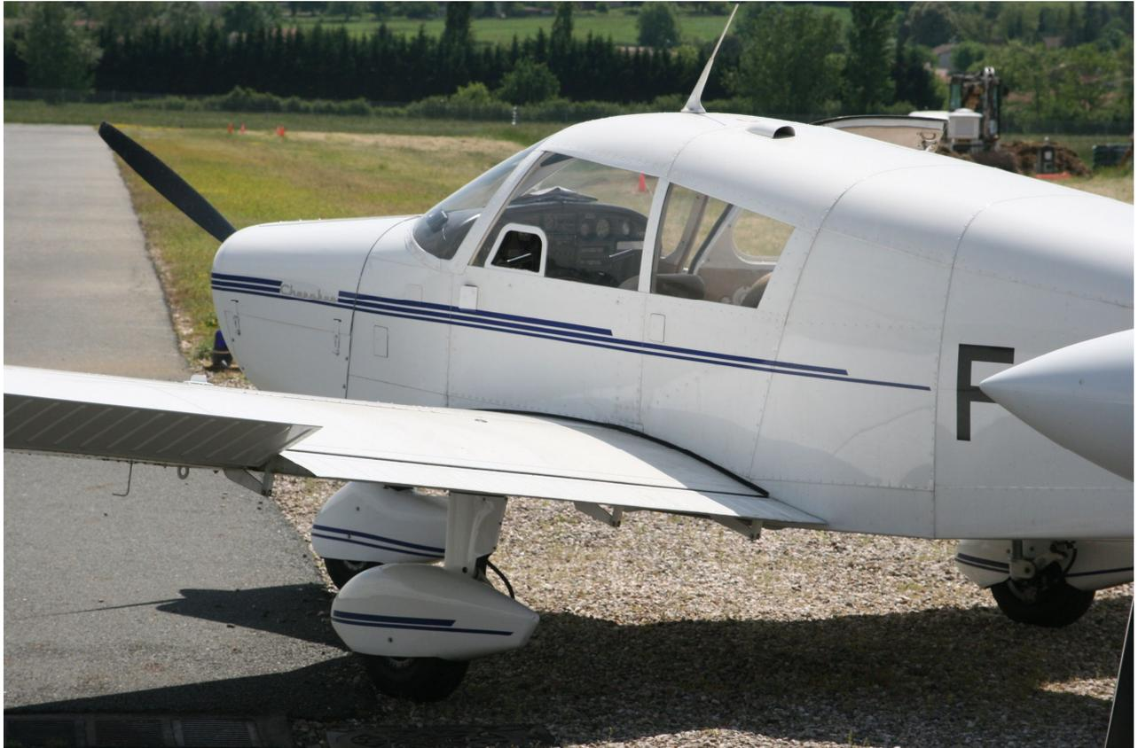
Le cahier des charges est assez simple. Monomoteur à pistons de 4 cylindres à plat Lycoming de 150 Cv, cellule entièrement métallique, ailes basses d'une envergure de 30 pieds (9,45 m) et train tricycle à empattement large de 3 mètres avec trois roues identiques, le moins d'éléments possible à assembler (moins de la moitié du PA 24) et d'un faible coût à la vente.
