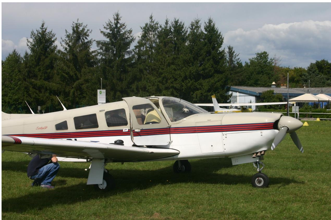
**A partir de 1979**, le PA 28 235 Cherokee Pathfinder disparaît des lignes de production pour être remplacé par le **PA 28 236 Dakota**. C'est un Archer II avec deux réservoirs par ailes, un nouveau train d'atterrissage, de nouveaux carénages de roues et un nouveau moteur Lycoming O 540 J3A5D fonctionnant avec de la 100LL. Les caractéristiques s'avèrent voisines de celles du PA 28 235.
