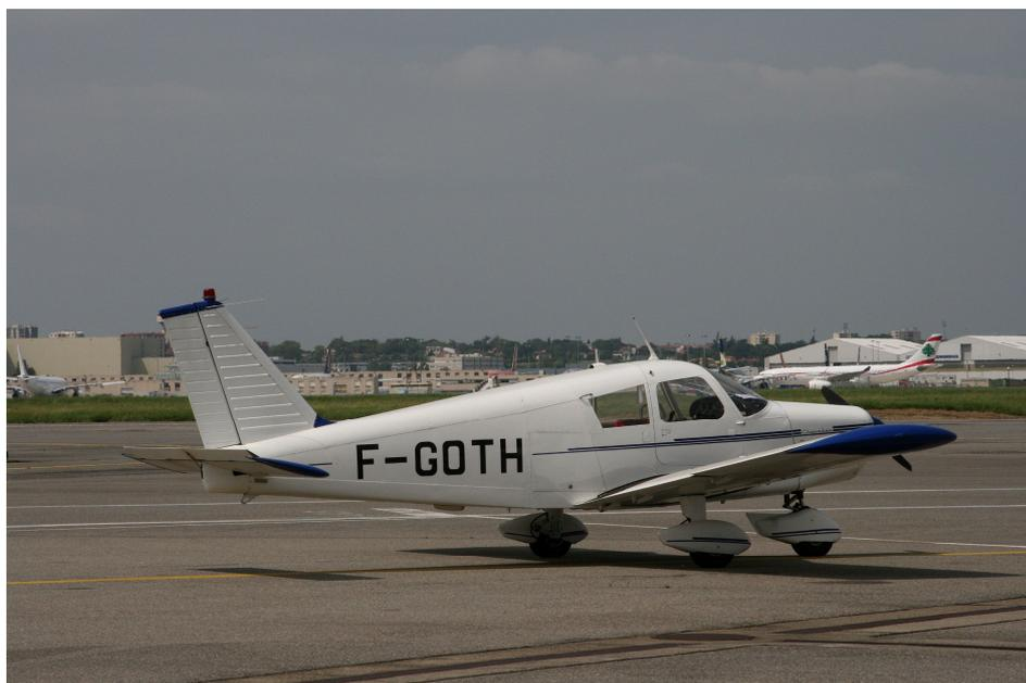
Parallèlement, le secteur développement de Piper Aircraft construit un **PA 28-150 Cherokee** dont le moteur Lycoming (O-320-A2B ou O-320-E2A) consomme de l'essence avec un indice d'octane de 80. La machine, d'un poids de 975 Kg en pleine charge, est certifiée le **2 juin 1961**.
